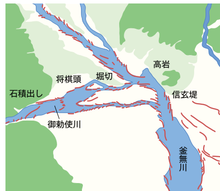
図1-1 武田信玄の治水工事の全体図
